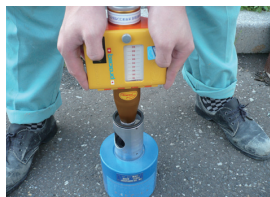
●テストアンビルによる 点検
